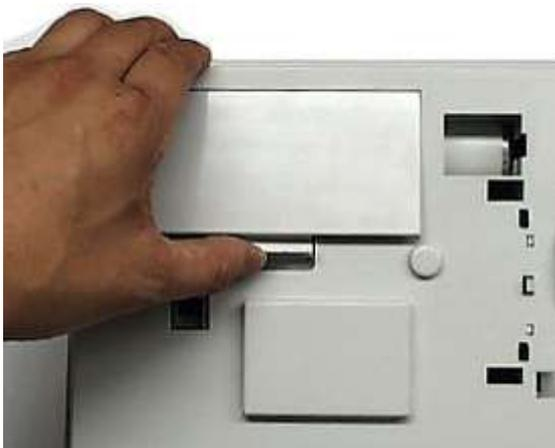
2. 乾電池（単二型）×4本を極性に注意して確実にセットします。
