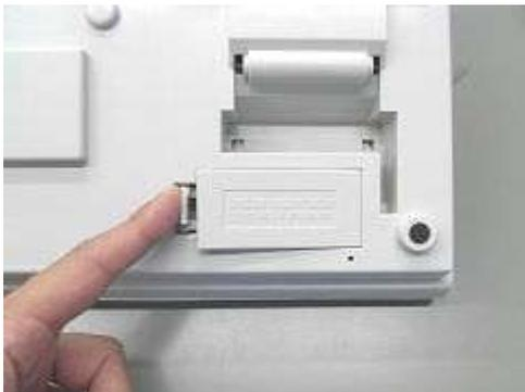
2. 乾電池（単三形）2 本を、極性に注意して確実にセットします。
