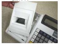
インクロールの左側を持って上方向に取り 外します。
