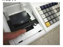
4. 新しいインクロールを差し込みます。 (インクロール右側から差し込み、「パチッ」と 音がするまでしっかり差し込んでください。)
